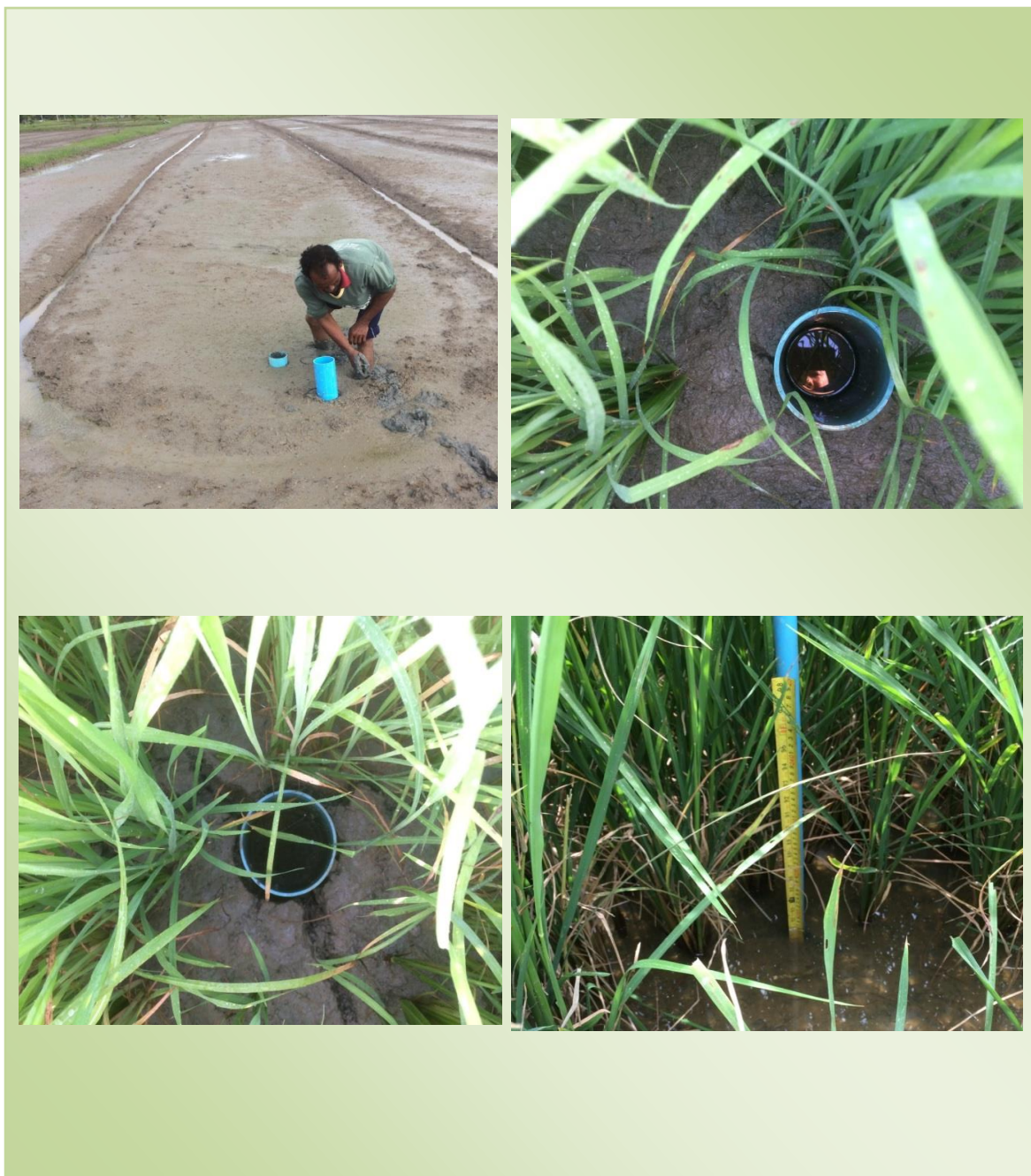
ภาพที่ 3 การเตรียมแปลงติดตั้งท่อระดับน้ำและตรวจเช็คระดับน้ำในแปลงนา
